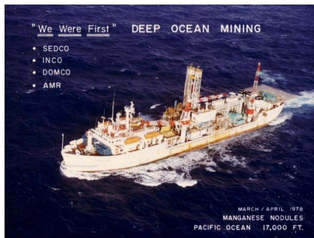
筆者が参画した OMI 国際ジョイント・ベンチャーのマンガン団塊探鉱船、SEDCO0445（三井造船建造）1978 年、南太平洋で 1,000 トンのマンガン団塊を採鉱した。
